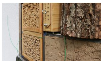
Abb. 2: Integrierte Wildbienen-Nisthilfe mit Thermodrähten zur Erfassung der Oberflächentemperatur. (Foto: IABP)
